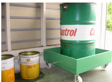
切削屑油抜タンク
