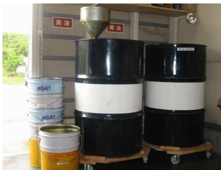
廃油保管場所
