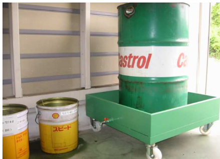
切削屑油抜タンク
